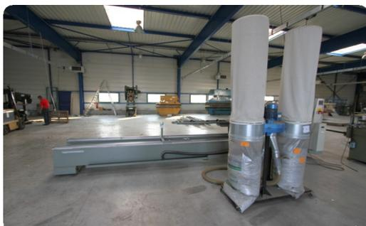
La machine est constituée d'une embase en tôle d'acier sur laquelle sont fixées deux barres d'acier à haute résistance : elles ont pour fonction de guider la tête de sciage mobile dans son déplacement.
