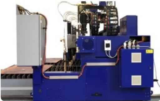
La construction particulièrement robuste, la grande rigidité, les guidages linéaires précis sur le portique (rails à billes) et les chemins de roulement fabriqués à partir de rails de chemin de fer S49 fraisés garantissent une qualité exceptionnelle et une durée de vie longue.
