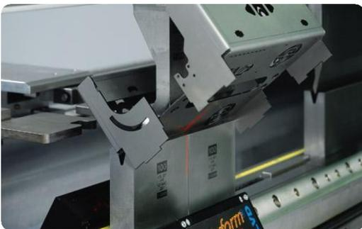
Easy-Form® laser, sont équipées de composants hydrauliques et électroniques de dernière génération, et sont définies en configuration multi-axes afin de convenir à une large gamme d'applications de pliage.
