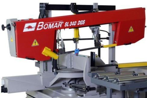
Machine montée sur bâti avec une hauteur de travail de 760 mm.
