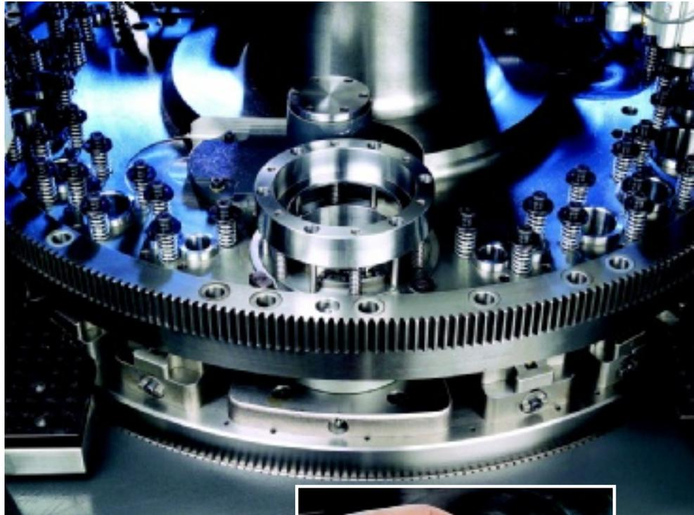
*Les fourreaux de guidage en acier trempé assurent un guidage précis des outils à long terme et peuvent être rapidement remplacés en cas d'usure.*
